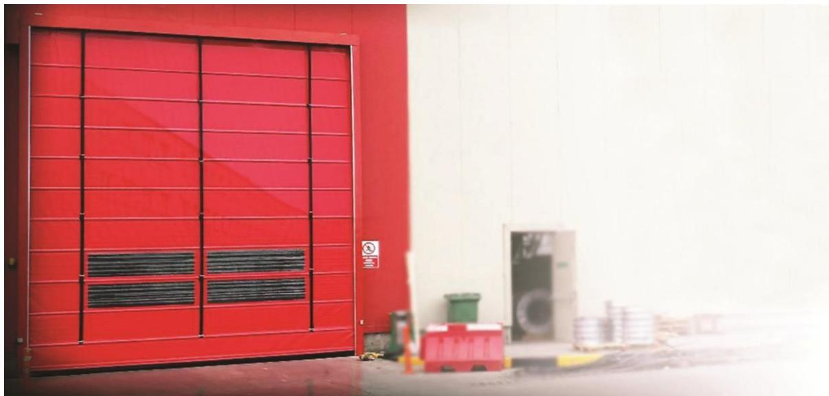
**درب فولاداپ سریع السیر :** دربهای سریع السیر بصورت فولاداپ مشخصات فنی : درب هایی از جنس ابریشم بافته شده با سرعت ۸۰ تا ۱۳۰ سانتی متر بر ثانیه ، تا ابعاد ۶/۵\*۵/۶ متر با مقاومت سرعت باد ۸۰ تا ۱۴۰ کیلومتر بر ساعت ، بصورت پلیسه به سمت بالا جمع میشود .
