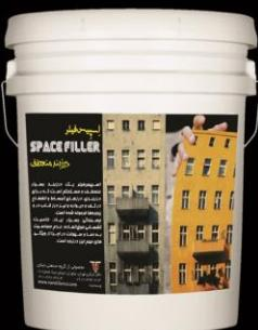
اسپیس فیلر پوشش تکجزی بر پایه رزین اکریلیک و پُرکننده بسیار الاستیک درزهای انقطاع و انبساط است. اسپیس فیلر بسیار چسبنده بوده و به خوبی به دو سطح مجاور درز می‌چسبد. خاصیت الاستیک بیش از ۵۰۰ درصدی اسپیس فیلر سبب می‌شود که ریزلرزهای ساختمان و انبساطها و انقباضات ناشی از تغییر دما و فصول، روی کارایی آن اثر نگذارد و ضمناً مصالح بکار رفته در دو سطح جانبی درز، دچار تخریب و شکستگی نگردد.
